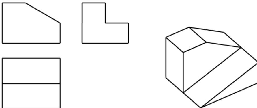
28. 根据立体图，补绘投影图中所缺的线。
